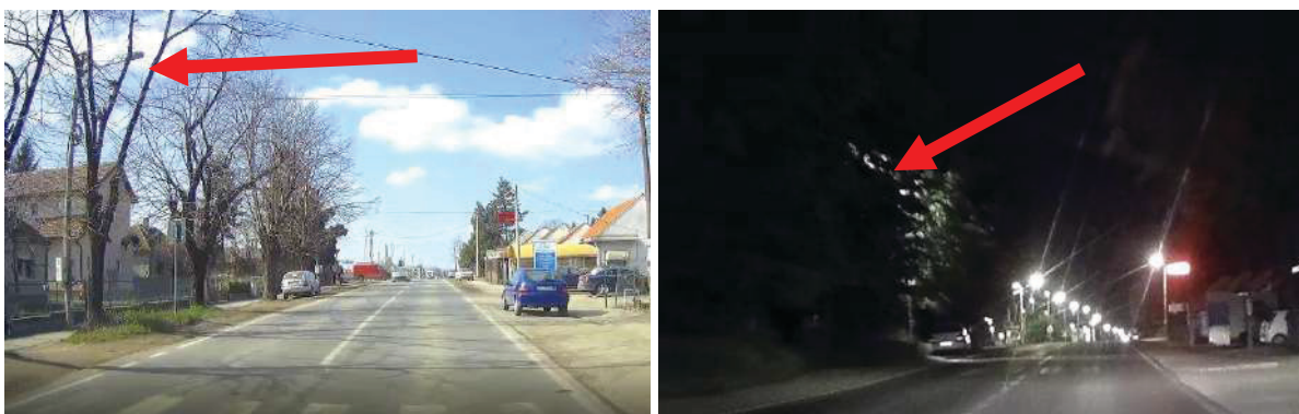
Слика 11.28 – Пример крошњи дрвећа које заклањају сноп светлости
