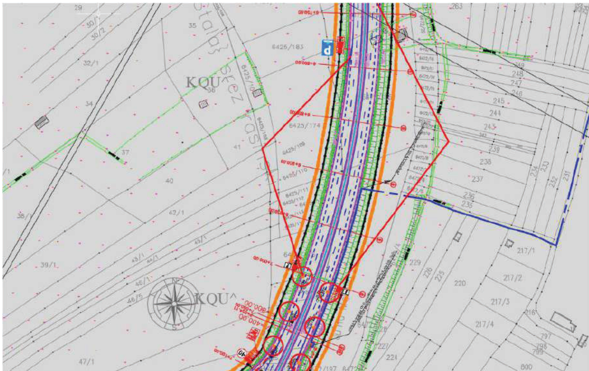
Слика 15.26 – Већи део уливно - изливних трака није обухваћен расветом
