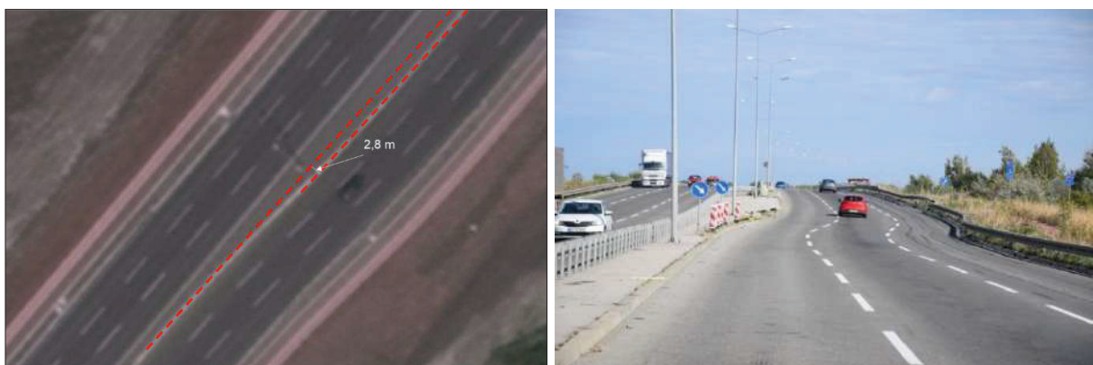
Слика 14.31 – Промена попречног профила пута у зони превоја и путног објекта
