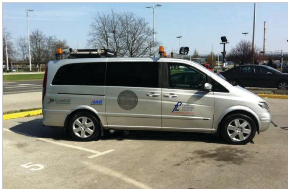
Слика 16.8 – Пример специјализованог возила које се користи за снимање путева
