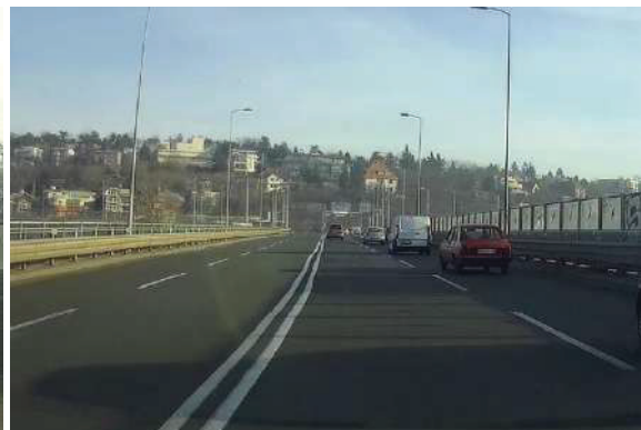
Слика 14.36 – Већи подужни и недовољан попречни нагиб, место превођења воде преко коловоза у хоризонталним кривинама
