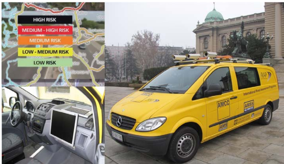
Слика 4 - Возило и опрема која се користи за iRAP/EuroRAP методологије
