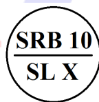
Слика 3. Жиг за накнадну уградњу граничника брзине, где „x“ представља бројчану ознаку радионице
