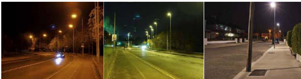
Слика 1.14. Пример различитих типова филамента, лево – наранџасти SOX, лош избор, средина – бели SON, бољи избор, десно – бели, метал халид, најбољи избор (Извор: „The Design Manual for Urban Roads & Streets“ Ирска влада, 2019)
